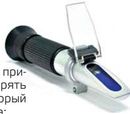
Рефрактометром является прибор, предназначенный измерять концентрации эмульсии, который можно разделить на два типа:
