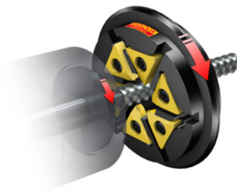
Вращение заготовки и корпуса фрезы осуществляется в одном направлении
