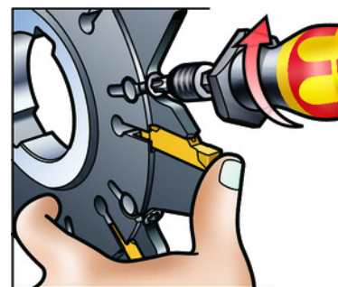
При установке пластины в базовом гнезде, немного надавите на неё, чтобы убедиться, что она встала до упора и только после этого затяните винт.
