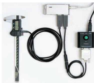
Пример использования с прямым соединением USB
