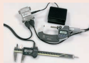
Пример применения с педальным переключателем (дополнительные принадлежности)
