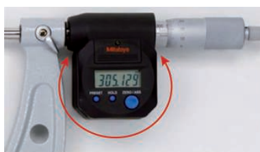
Дисплей поворачивается на 330°
