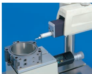
Измерение глубоких канавок
