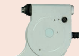
Регулировочный винт для компаратора ± 5 мкм
