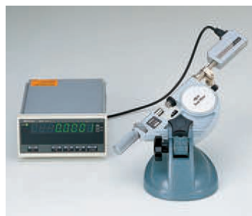
Пример применения: с линейным датчиком
