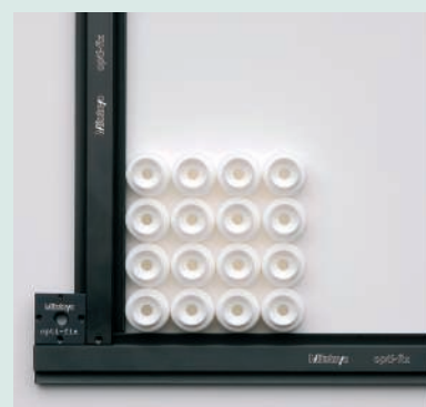
Измерение партии идентичных деталей, помещенных в прямоугольную раму.
