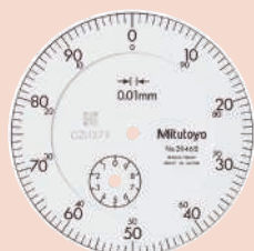
Непрерывная шкала (Двунаправленная градуировка)
