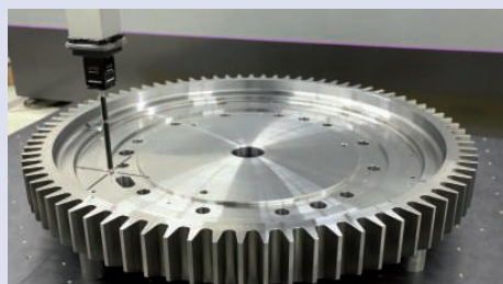
Сканирование головкой SP80 и щупом 100 мм.
