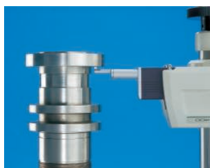
Измерение в перевернутом положении
