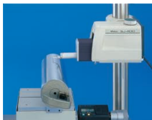
Измерение радиусной поверхности
