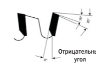
Угол подходит для обработки заготовок сплошного сечения из легких сплавов.
